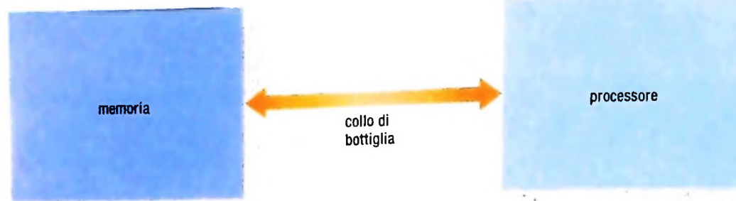
Architettura della macchina di Von Neumann. La struttura è costituita da tre parti distinte: un unico processore, una memoria lineare e un canale di collegamento (definito da Backus "collo di bottiglia") che permette il passaggio di una parola alla volta.
