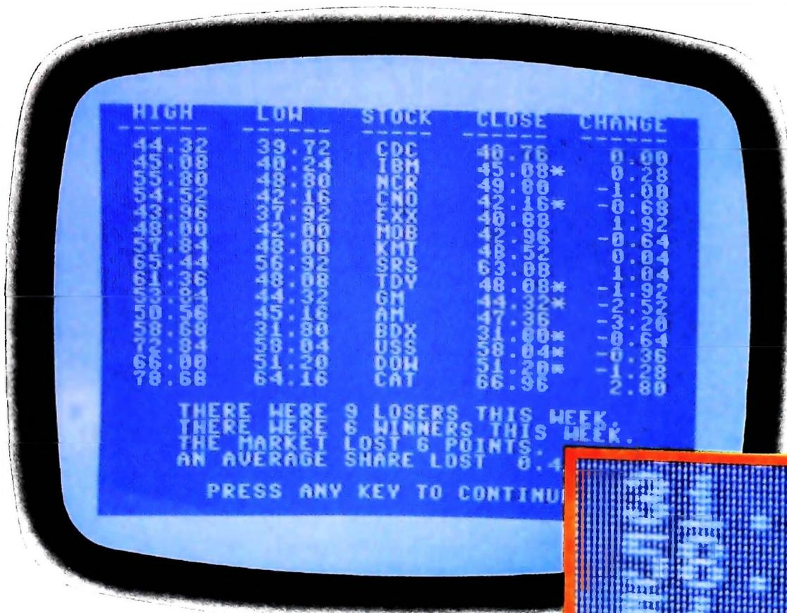
Nei monitor a colori i fosfori impiegati sono di tre tipi diversi: blu, rossi e verdi, eccitati da tre distinti fasci di elettroni. La combinazione di questi tre tipi di fosfori è in grado di riprodurre le più diverse variazioni cromatiche. È da notare che, a seconda del tipo di fosforo, si ha una maggiore o minore persistenza dell'immagine sul video.
