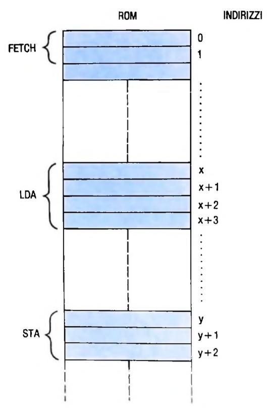
dell'istruzione nella ROM. A ogni CLOCK l'indirizzo s'incrementa fino ad esaurire l'istruzione.
