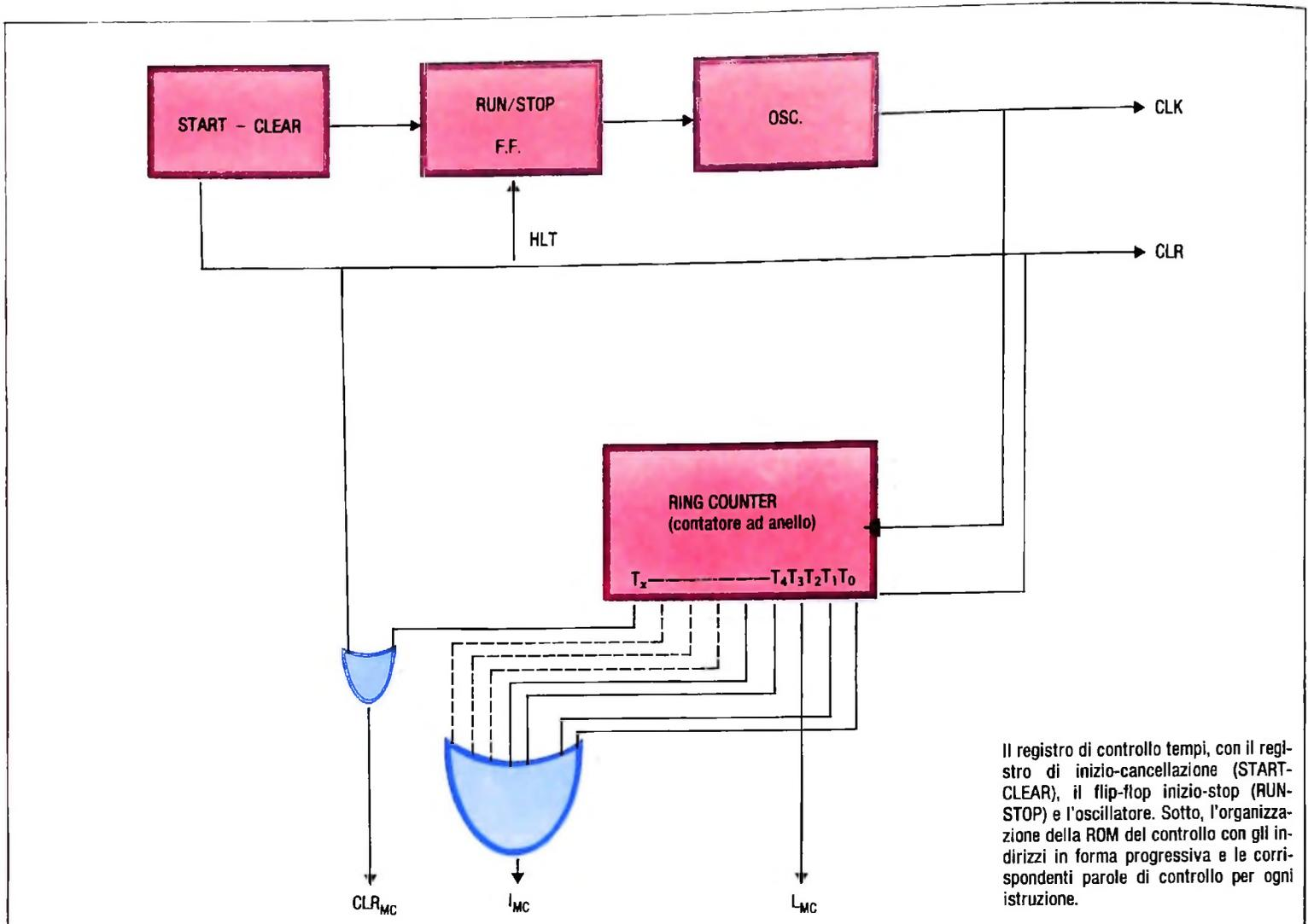
Il registro di controllo tempi, con il registro di inizio-cancellazione (START-CLEAR), il flip-flop inizio-stop (RUN-STOP) e l'oscillatore. Sotto, l'organizzazione della ROM del controllo con gli indirizzi in forma progressiva e le corrispondenti parole di controllo per ogni istruzione.
