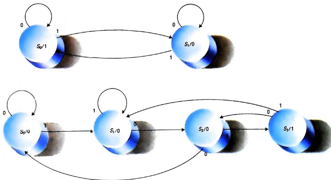
Una macchina per il controllo della parità, in alto: quando ha ricevuto un numero pari di 1 la sua uscita è 1, mentre è 0 quando ha ricevuto un numero dispari di 1. Il grafo di transizione in basso rappresenta invece una macchina a stati finiti che dà in uscita 1 solo quando riceve in ingresso la stringa 101 e in ogni altro caso dà in uscita 0.
