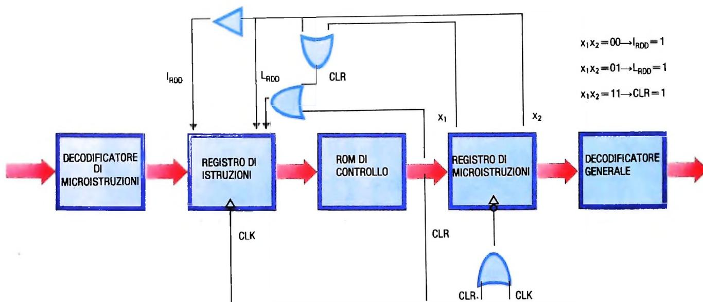
La struttura complessiva del controllo. Sopra, l'insieme dei registri per la trasformazione delle istruzioni in parole di controllo, il circuito di retroalimentazione e controllo automatico della gestione dell'istruzione. Sotto, il registro di START-CLEAR, il flip-flop RUN-STOP e l'oscillatore.
