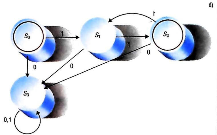
Le figure di questa pagina presentano i grafi di transizione per quattro macchine a stati finiti che possono essere viste come riconoscitori. La a) è una macchina che riconosce l'insieme formato da un solo 0. La b) riconosce l'insieme i cui elementi sono stringhe di un
