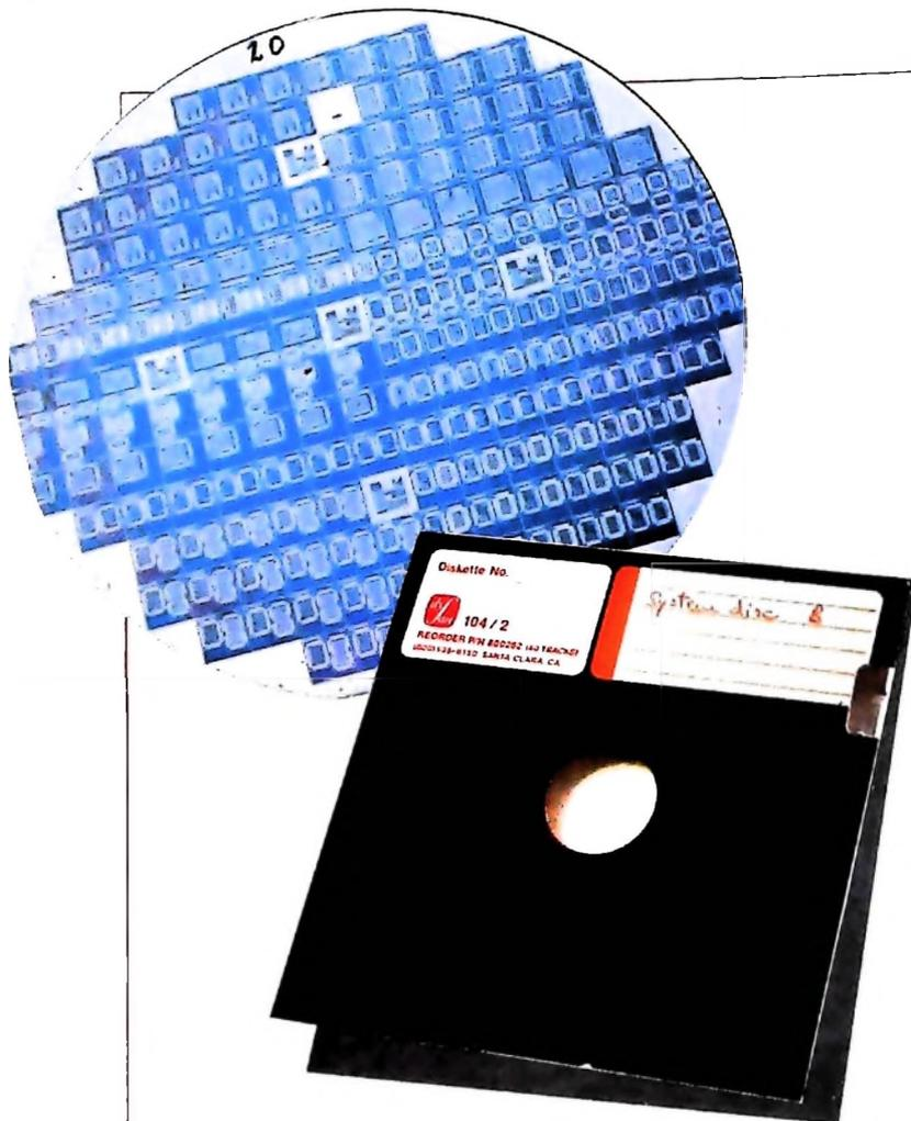
Un wafer di silicio su cui sono stati disegnati vari chip di memoria RAM e un dischetto flessibile (un supporto di memoria di massa).
